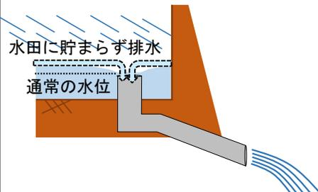
排水管（塩ビ管）を越流した時点で、水田から排水が開始。
