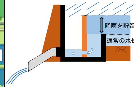
堰板の小さな穴により、排水が抑制され、水田内に雨水が貯留。
